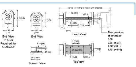
PTA25 Tilting Plate Trunnion for GD16C2, GD3J2, GD210LP, DD200 and DD300 Rotary Tables – Dimensions
